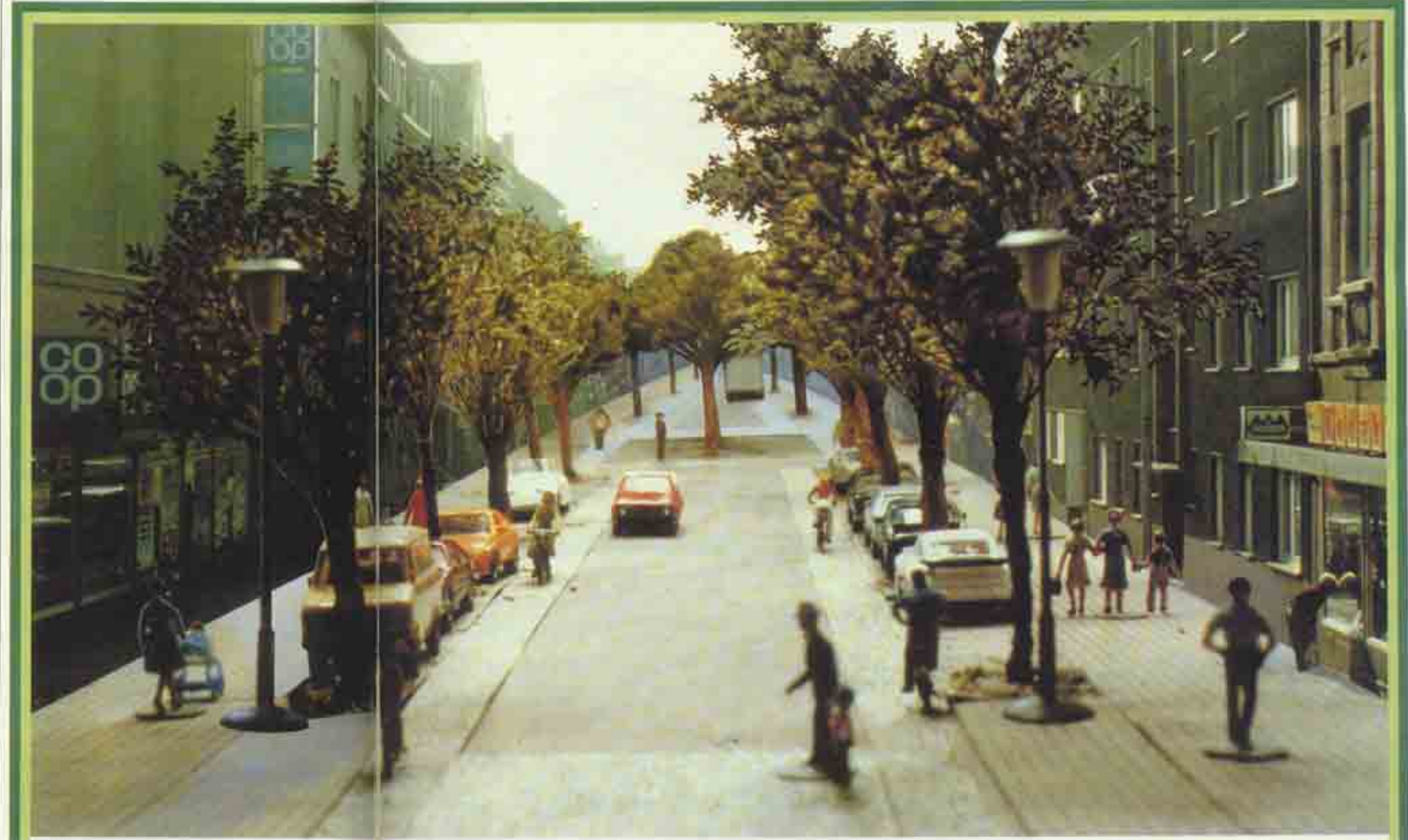
Der Normalfall: Der Mehrzweckstreifen schafft keinen Sicherheitsabstand für Fußgänger, sichert die Rechte der Radfahrer am Fahrbahnrand, bremst die Autos.
